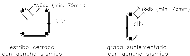
Fig. 21.1d Ganchos sísmicos en estribos y grapas suplementarias
