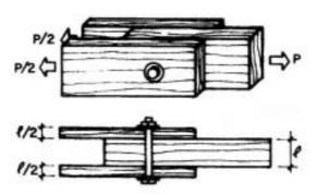
Fig. 10.3.2.2a Unión empernada a doble cizallamiento Cargas paralelas al grano en todos los elementos (Carga P).
