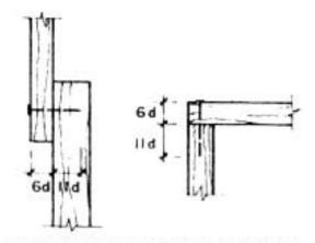
10.2.4.1a Espesores mínimos y penetración de clavos sometidos a cizallamiento simple
