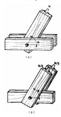
Fig. 10.3.2.3. Unión empernada, cargas inclinadas con relación al grano
