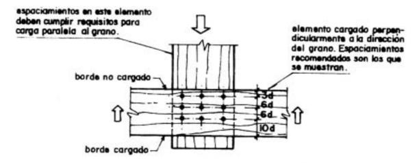
Fig. 10.2.5.3b Elementos cargados perpendicularmente al grano.
