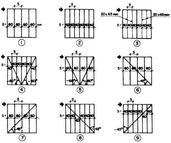
Fig. 8.6.1. Tipos de entramados
