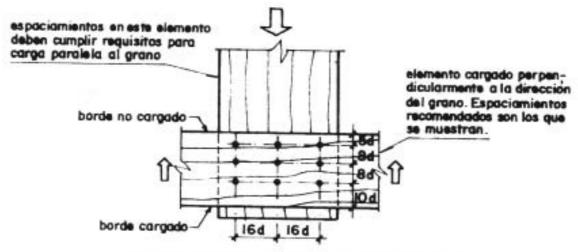
Fig. 10.2.5.2b Elementos cargados perpendicularmente al grano.
