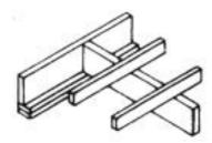
d) Relación h/b = 5; deberá restringirse el desplazamiento lateral de los apoyos y además el borde en compresión mediante un entablado continuo.
